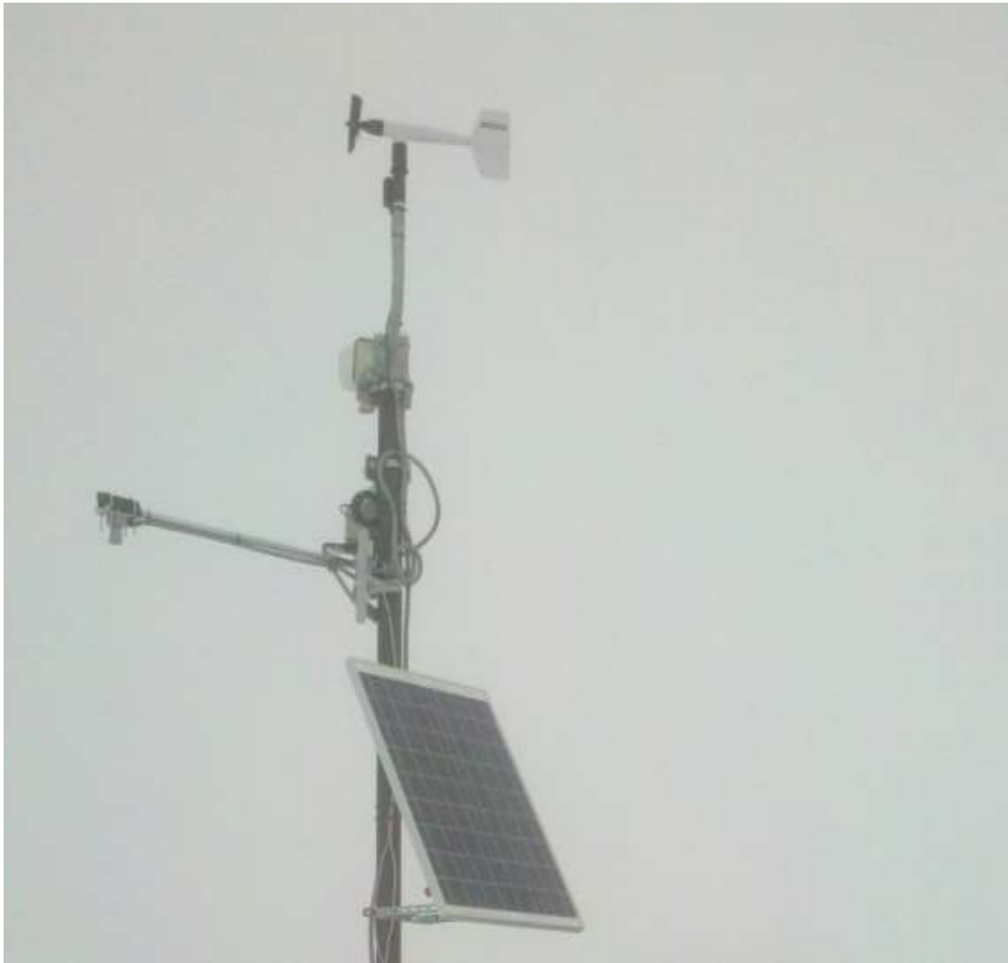
Figura 2.3: dettagli realizzativi del modulo B; data la quota di installazione si è optato per un anemometro che dovrebbe in grado di resistere alle rigide condizioni invernali; a sinistra è visibile anche il sensore di altezza neve installato nel mese di novembre.
