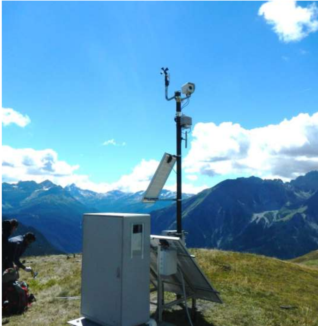
Figura 2.1: visione d'insieme delle due postazioni di monitoraggio; in primo piano a sinistra è visibile la postazione A con relativi pannelli solari, sullo sfondo la postazione B
